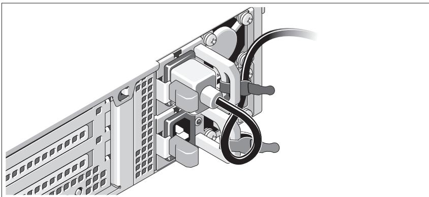
システムの電源ケーブルをループ状に曲げ（図を参照）、付属のストラップでブラケットに固定します。電源ケーブルのもう一方の端をアースされた電源コンセントまたは UPS（無停電電源装置）や配電装置（PDU）などの電源に接続します。
