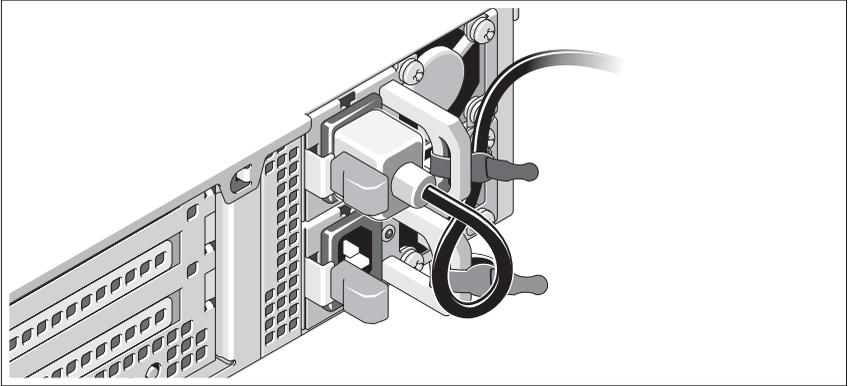
Bengkokkan kabel daya sistem dalam bentuk lingkaran seperti ditunjukkan pada gambar dan ikat kabel ke braket dengan pengikat yang tersedia. Tancapkan ujung kabel daya yang lain ke stopkontak listrik yang ditanahkan atau sumber daya terpisah seperti catu daya tak terputus (UPS) atau unit distribusi daya (PDU).
